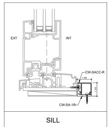
FLASHING ATTACHMENT ANGLE & SILL NAIL FLANGE IS NOT AVAILABLE FOR UNIVERSAL DOORS
